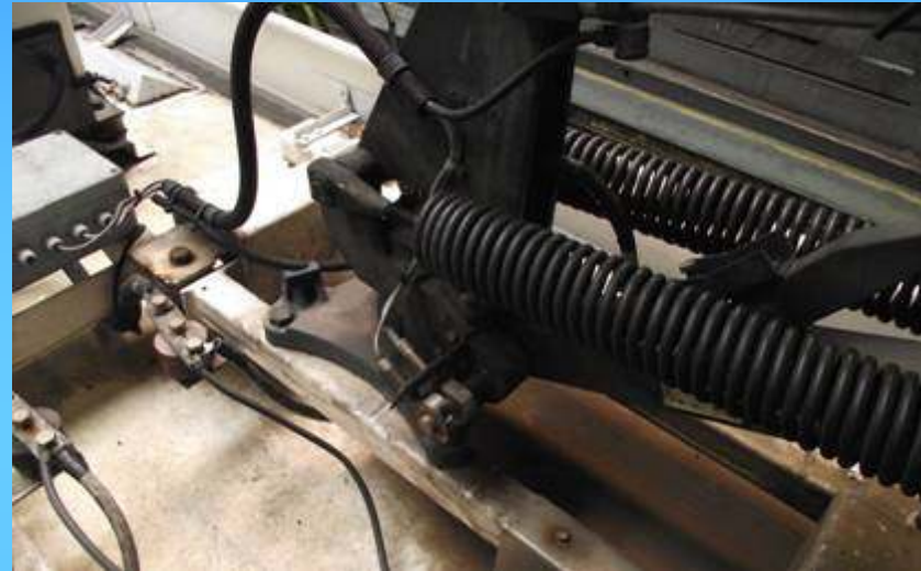
Az áramszedő helyzetét érzékelő szöghelyzet-jeladók
