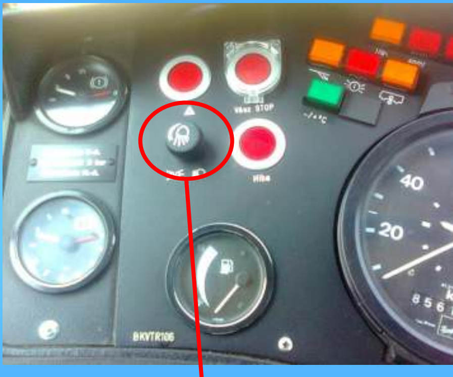
Külső világítás kapcsolója
