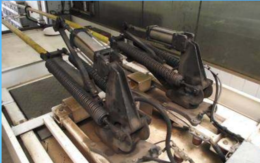
Áramszedőt mozgató pneumatikus munkahengerek
